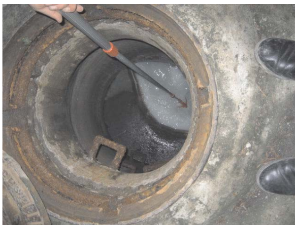
Slika 1. Uzorkovanje otpadne vode / Figure 1. Sampling of waste waters
